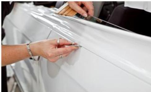
An weicher Gummileiste wird die Folie mit einem Überstand von 2 Millimetern weggeschnitten und danach unter die Gummidichtung gerakelt. Der Einsatz von Knifeless Tape wird empfohlen.
